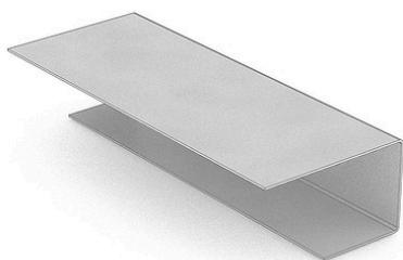
Le profilé PlaGyp® PU27/48 est un profilé en forme de U périphérique pour le système de plafond PlaGyp® à utiliser en combinaison avec les plaques Gyproc® destinées au parachèvement à sec. Le profilé est laminé à froid suivant NBN EN 14195:2015, en acier thermozingué (Z100 suivant NBN EN 10346:2015) avec une épaisseur de 0,6 mm, dimensions de 27 mm x 28,2 mm x 48 mm et une longueur de 4000 mm.
