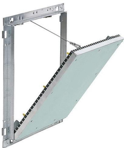
La trappe de visite ProLock Steel EI 60 Cloison est composée d'un cadre extérieur fixe et d'un cadre intérieur amovible, les deux en acier galvanisé avec une épaisseur de 1,5 mm.
