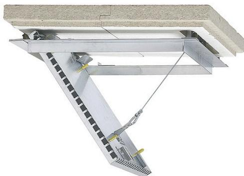
La trappe de visite ProLock Steel Plafond EI 30 est composée d'un cadre extérieur fixe et d'un cadre intérieur amovible, les deux en acier galvanisé avec une épaisseur de 1,5 mm.
