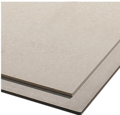
L'élément de chape sèche Rigidur® E 20 est composé de deux plaques de plâtre renforcé aux fibres de cellulose GF-C1-I-W2 suivant NBN EN 15283-2:2009, qui sont collées et agrafées l'une sur l'autre avec un décalage de 50 mm et est destinée au parachèvement intérieur.
