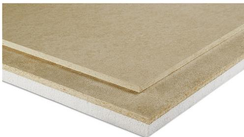
L'élément de chape sèche Rigidur® E 40 PS est composé de deux plaques de plâtre renforcé aux fibres de cellulose GF-C1-I-W2 suivant NBN EN 15283-2:2009, qui sont collées et agrafées l'une sur l'autre avec un décalage de 50 mm, revêtues à l'usine d'une couche de 20 mm de mousse de polystyrène. L'élément de chape sèche Rigidur® E 40 PS est destiné au parachèvement intérieur.
